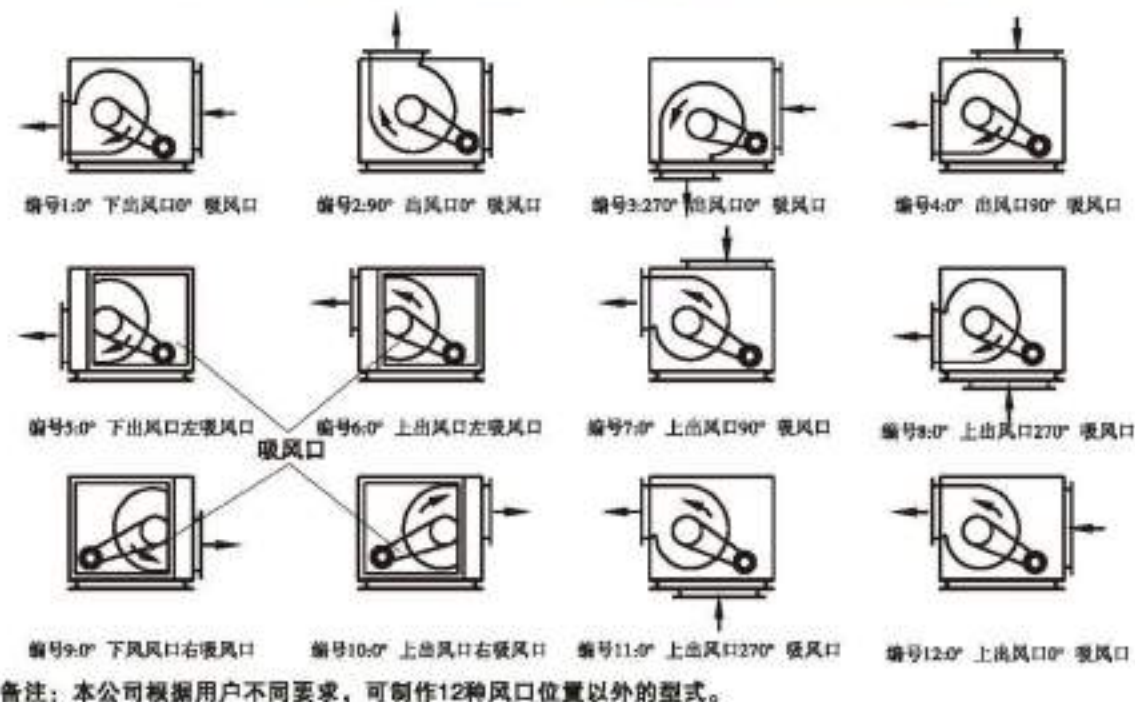
HTFC-V-B型消防通风（两用）低噪声柜式离心风机风口位置编号
